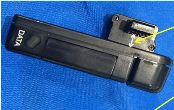
幅が、ノギス計測して実測 7.80mm±0.15mm程度で、
