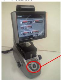
上記設定完了後 IM-6000にて連続測定を開始いたします。 本機のメジャーボタンで 測定データがQCプロへ取り込まれます。
